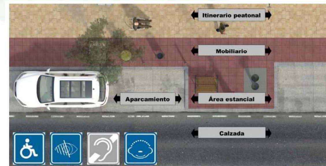
Ubicación de “bandas” (Fuente: Manual de Accesibilidad para Espacios Públicos Urbanizados. Ayto. Madrid)
